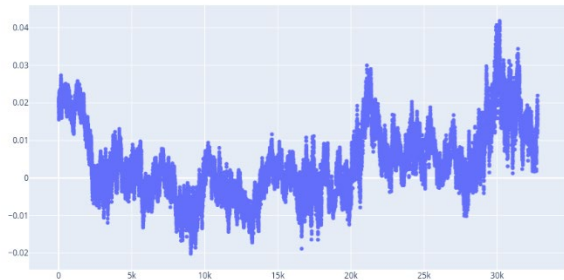
Рис. 3. Логнормальный каскад (на оси абсцисс отображены порядковые номера точек во временном ряде, на оси ординат – значения) с параметрами \nu = -\ln(2)/4 , \sigma = 0,1 ; описан в работе [2]
