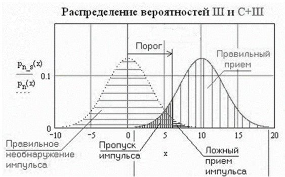
Рис. 5. Графики плотностей вероятностей шума и смеси шума и сигнала (графическая интерпретация критерия Неймана – Пирсона)
